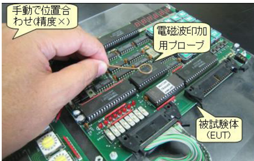
図 5-1 誤動作しやすい領域を探し出す方法(従来法)
