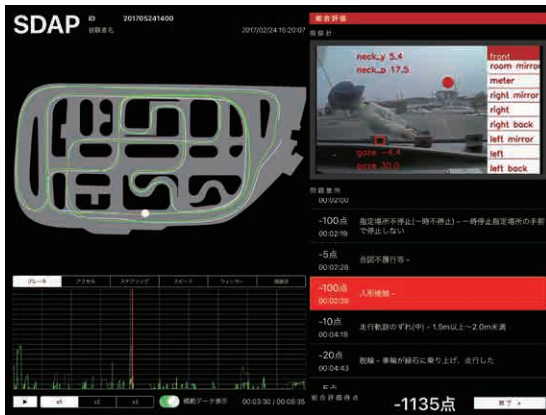
評価結果の例。ブレーキ、ステアリング等の操作量、走行軌跡、視線、適用された減点項目を確認でき、模範走行と比較できる。
